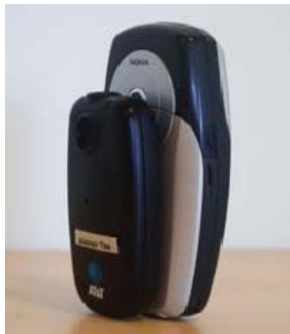
Ilustración 22. Dispositivo Active Bat conectado a un móvil con Bluetooth para correlar medidas de RSS con su localización.
