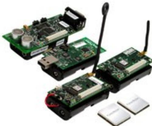
Figura 2.18.: Nodos sensores de Crossbow.
